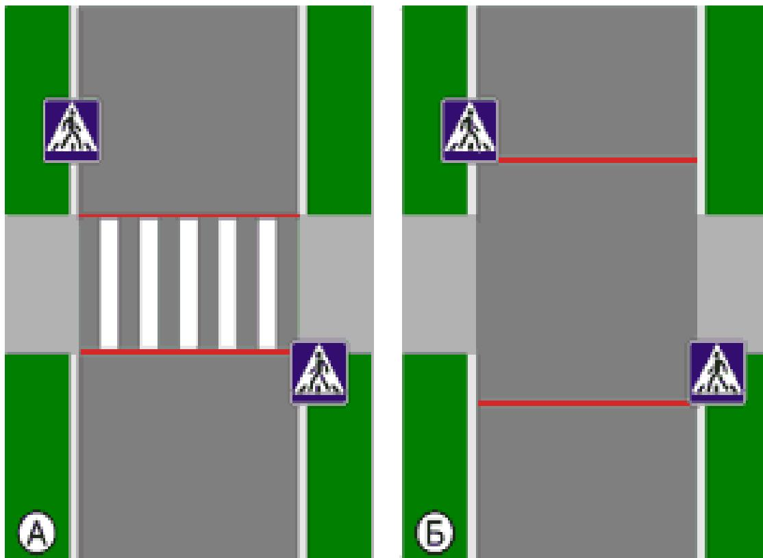
При наличии разметки, границы пешеходного перехода определяются границами разметки (вариант "А"), если дорожная разметка отсутствует — границы соответствуют установленным знакам (вариант "Б").
