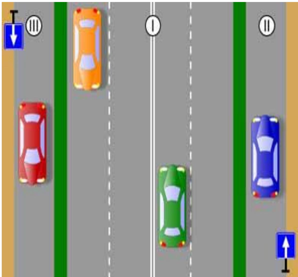
В качестве примера приведена дорога, на которой три проезжие части. Две из них (II и III) односторонние, установлены знаки 5.5 "Дорога с односторонним движением", а одна (I) двусторонняя.
