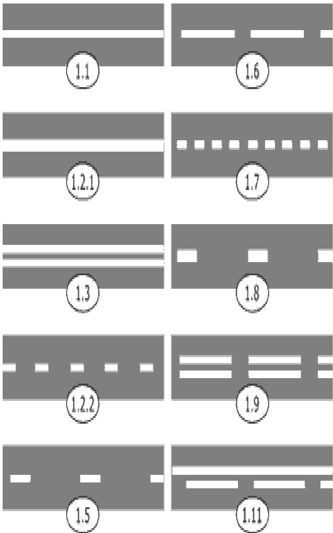
**Рис. 12 Разметка, наносимая продольно к проезжей части.**
