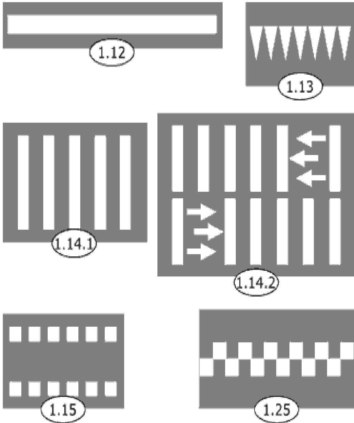
**Рис. 13 Разметка, наносимая перпендикулярно к проезжей части.**
