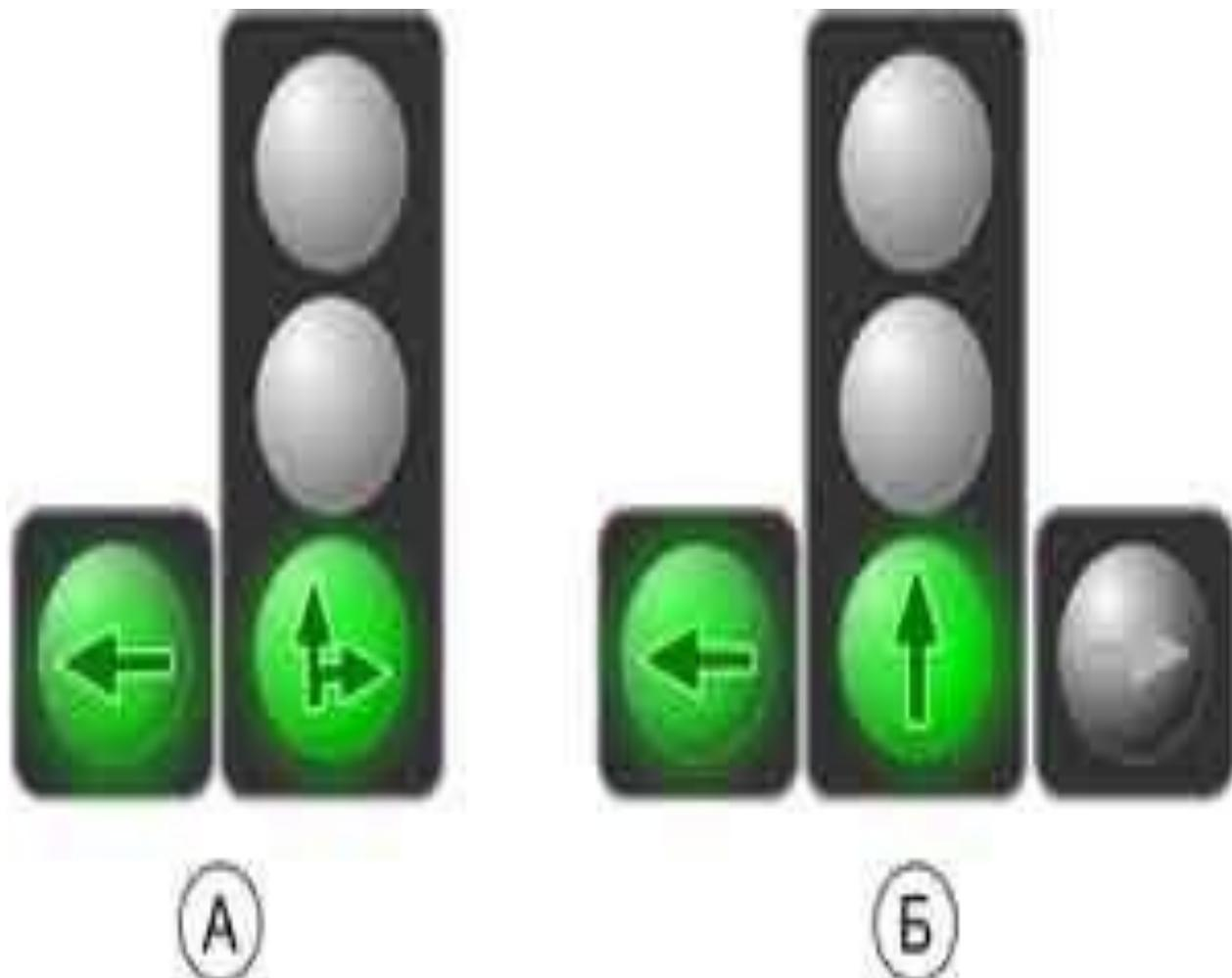
**Рис. 18 Светофоры, оборудованные дополнительными секциями в режиме, когда включен основной зеленый сигнал светофора.** Вариант А — Двигаться можно в любом направлении.
